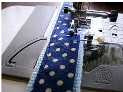
表布に底布を付けます。底布の上下を1センチずつ折り、表布の中央とあわせて縫い付けます。
